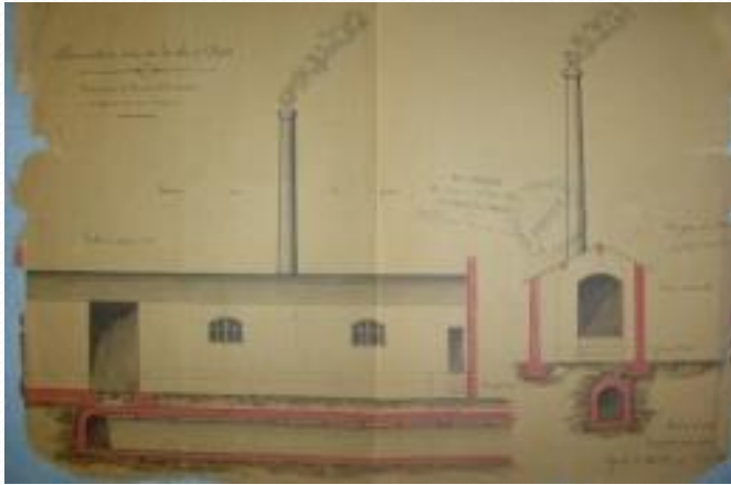
Bâtiments abritant le fourneau, la machine à vapeur et les pompes, 1880 (AMA, 1O)
