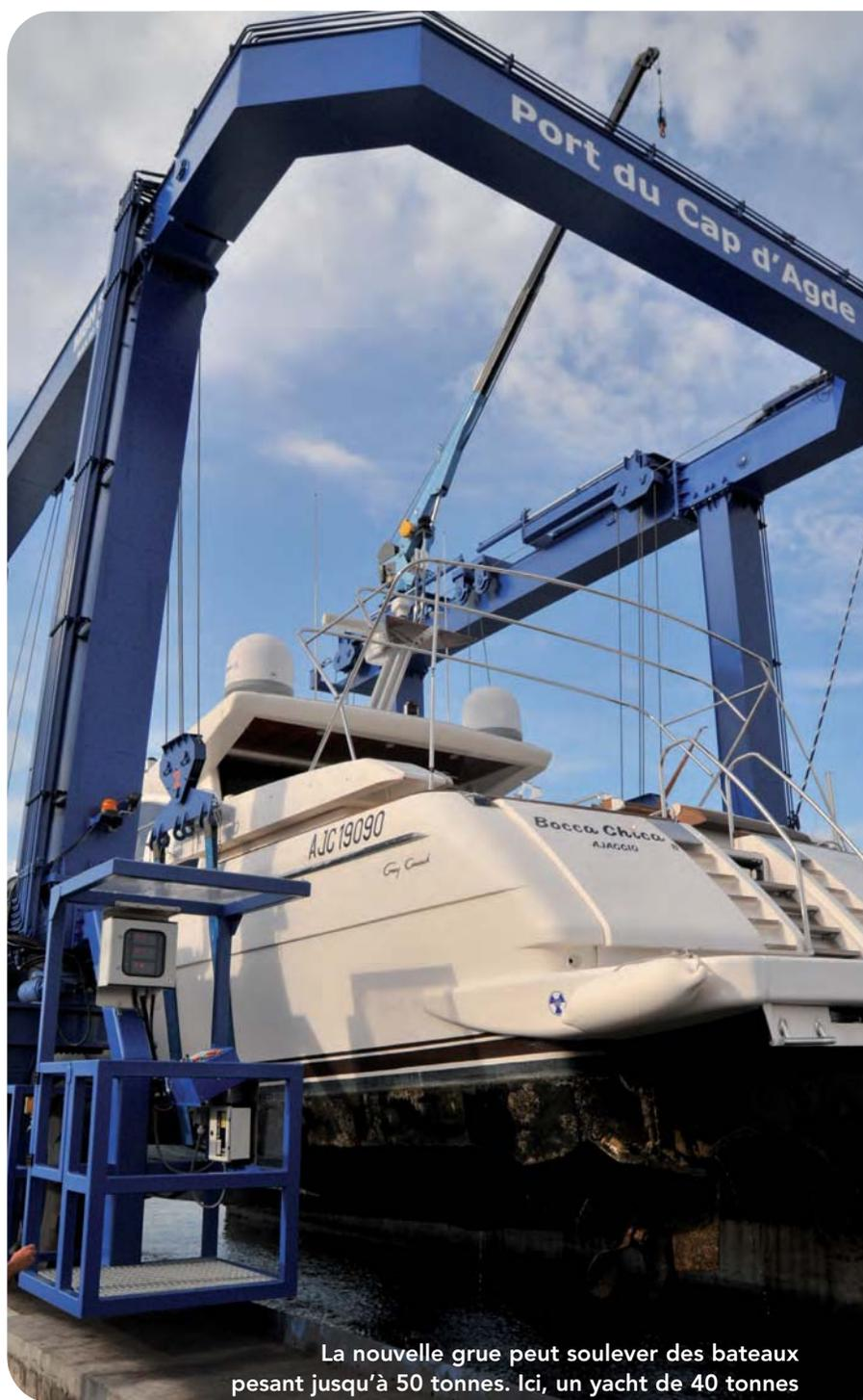
La nouvelle grue peut soulever des bateaux pesant jusqu'à 50 tonnes. Ici, un yacht de 40 tonnes
