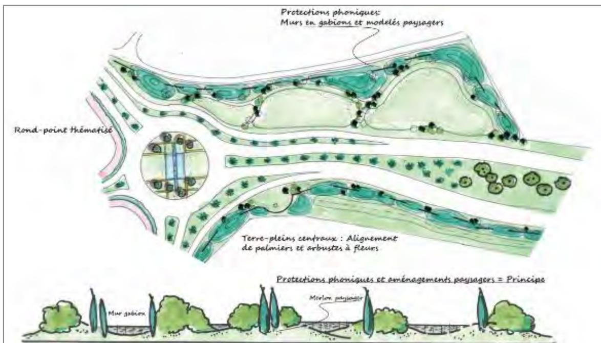
Figure 5 : Croquis et Schéma de principe concernant les protections phoniques (Source ; PMC Création)
